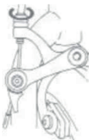
rys. 12b regulacja napięcia linki hamulca
