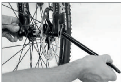
Wyciąganie sworznia przelotowego
