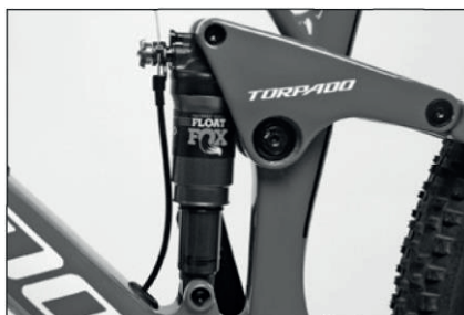
0-ring umieszczony w górnej części amortyzatora
