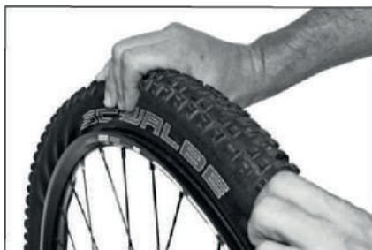
Wepchnij oponę w kierunku środka obręczy.
