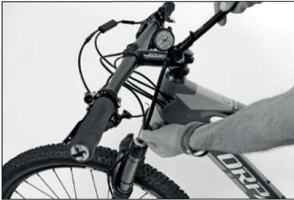
Ustawienie stałej sprężyny za pomocą pompki amortyzatora.
