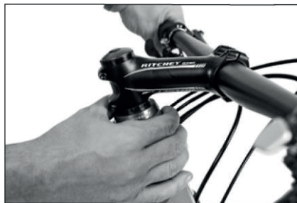
Aby sprawdzić luz w sterach należy zacisnąć hamulec przedni, mocno popychając rower do tyłu i do przodu, opierając się tułowiem na siodle.
