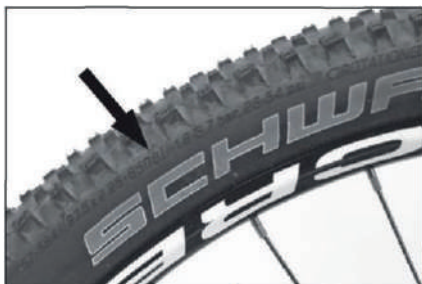
Wskazanie maksymalnego ciśnienia napompowania na boku opony.
