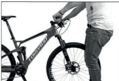
Spróbuj przesunąć kierownicę względem przedniego koła.
