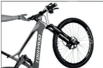
Podnieś przednie koło i upewnij się, że porusza się ono bardzo łatwo.
