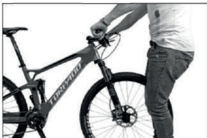
Spróbuj przesunąć kierownicę względem przedniego koła.
