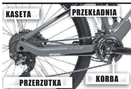
Układ napędowy z korbą, kaseta, przerzutką przednią i tylną.
