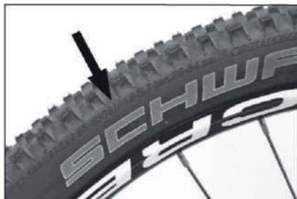
Wskazanie maksymalnego ciśnienia napompowania na boku opony.
