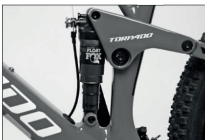
Przesunięcie 0-ringa na amortyzatorze wskazuje zastosowany skok.
