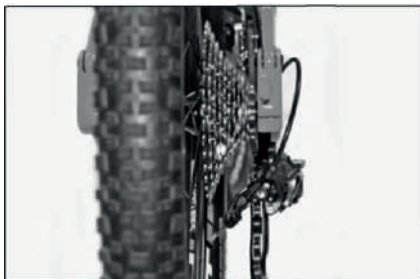
Przesuń łańcuch na najmniejszą zębatkę.
