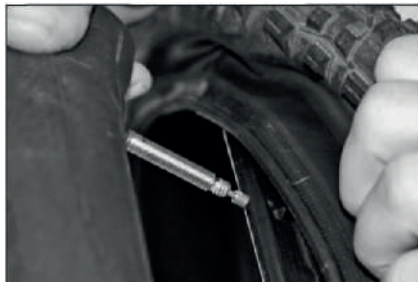
Włożyć wentyl do otworu obręczy.
