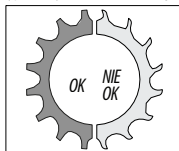
Ilustracja 5H(a) – Kontrola wzrokowa tarczy łańcuchowej i kół zębatach
