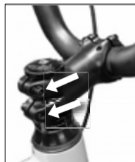
Obraz 3D – Minimalny znak włożenia mostka
