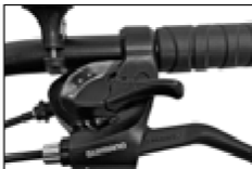
Tradycyjna manetka - pociągnięcie
