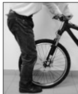
Zdjęcie 3G — Sprawdzanie prawidłowego połączenia łączenia mostka z widełkami
