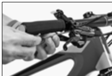
Ilustracja 4D(b) — Regulacja dźwigni hamulca
