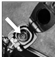
Śruba rozprężna – rowerskładany
