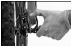
Ilustracja 6F(a) — Otwieranie dźwigni szybkiego zwalniania
