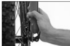
Ilustracja 6F(c) — Zamykanie mechanizmu
