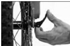
Ilustracja 6F(b) — Zamykanie dźwigni szybkiego zwalniania
