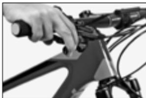
Imagen 4D(a) - Regulación de la palanca de freno
