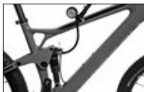
*En el caso de la suspensión neumática, será necesario ajustar la presión del aire*
