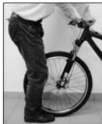
Imagen 3G - Comprobación de las condiciones correctas de unión de la unión entre la potencia y la horquilla
