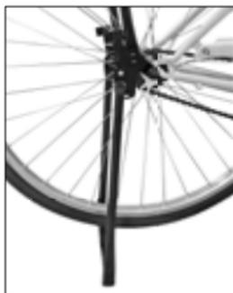
*Pata de cobra integrada en el*
