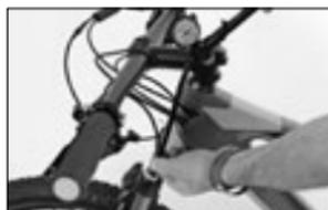
*Ajuste de la rigidez del muelle con una bomba para amortiguadores*
