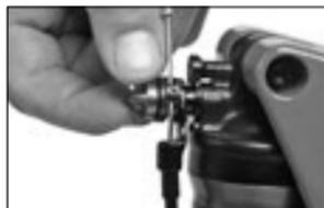
*El amortiguador se ajusta con una rueda de ajuste volante*
