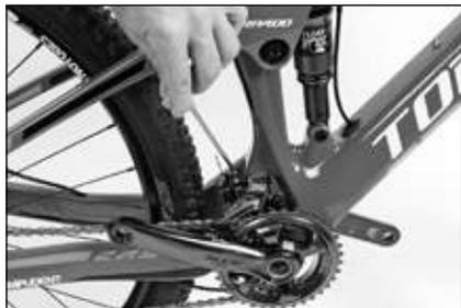
2. Utilizzare le viti di regolazione dei “fine corsa” per limitare la corsa del deragliatore.
