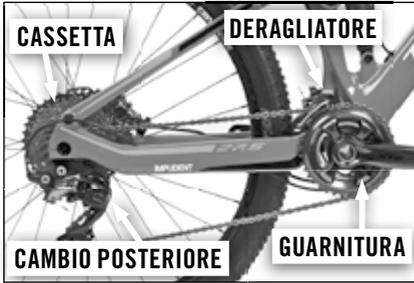
Sistema di trasmissione con indicazione di guarnitura, cassetta, deragliatore, cambio posteriore
