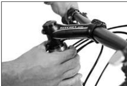
Per verificare il gioco della serie sterzo, azionare il freno anteriore, spingere avanti e indietro la Mtb Torpado, appoggiare una mano sulla calotta
