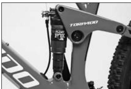
Lo spostamento dell'anello O sull'ammortizzatore indica la corsa impiegata
