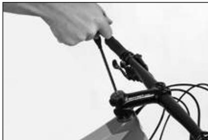
Dopo aver allentato le viti di bloccaggio laterali regoli il gioco dello sterzo con la vite di registrazione incassata in alto
