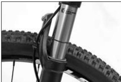
In base allo spostamento della fascetta potrà stabilire la corsa impiegata
