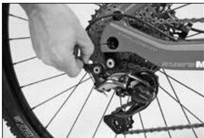
1. Registrare la tensione del cavo con la vite di registrazione.
