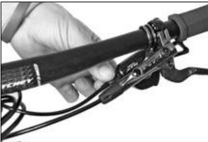
1. Regolare il tensionamento con la vite attraverso la quale il cavo entra nella leva del cambio.
