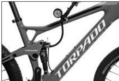
Nel caso di ammortizzatori pneumatici sarà necessario regolare la pressione dell'aria
