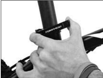
Per impostare l'altezza di seduta è necessario svitare la vite della chiusura del reggisella, oppure aprire il bloccaggio rapido
